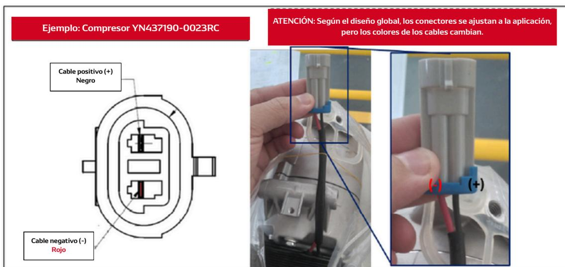
La correcta instalación de este compresor es necesaria para evitar la quema del diodo interno del embrague magnético. A continuación, se explica el funcionamiento normal y también en caso de conexión invertida.
