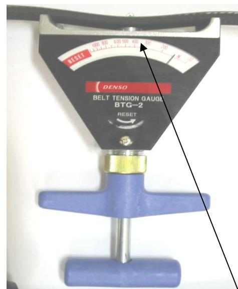
PRESSONAR A ALAVANCA ATÉ O PINO CENTRAL SE ELEVAR E PRESSONANDO A CORREIA EM TODA PARTE SUPERIOR, POSTERIORMENTE VERIFICAR O VALOR MEDIDO NO MOSTRADOR.
