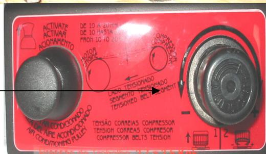
PARA REGULAGEM DA TENSÃO DA CORREIA (COMPRESSOR / ALTERNADOR) TEMOS UM PARAFUSO QUE AO GIRARMOS NO SENTIDO HORARIO AUMENTAMOS A TENSÃO DA CORREIA E NO SENTIDO ANTI-HORARIO DIMINUIMOS A TENSÃO DA CORREIA .
