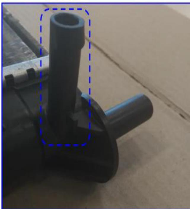
NOTA: Caso o veículo tenha a mangueira de retorno ao reservatório de expansão, necessário que o cliente desobstrua mecanicamente este tubo, para o perfeito funcionamento do sistema.
