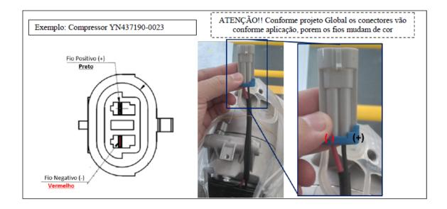
A correta instalação deste compressor se faz necessário para evitarmos a queima do diodo interno da embreagem magnética, abaixo segue explicação de funcionamento normal e também em caso de ligação invertida.
